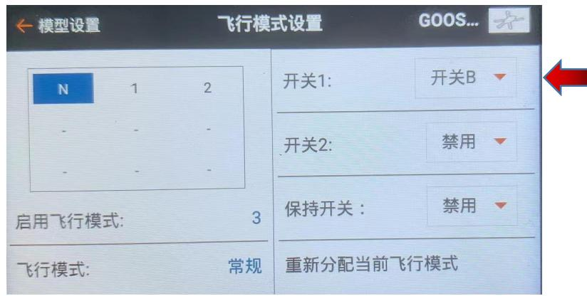
5. 设置 CH5 为起落架模式，设置开关用于控制姿态模式/3D 手动模式切换
