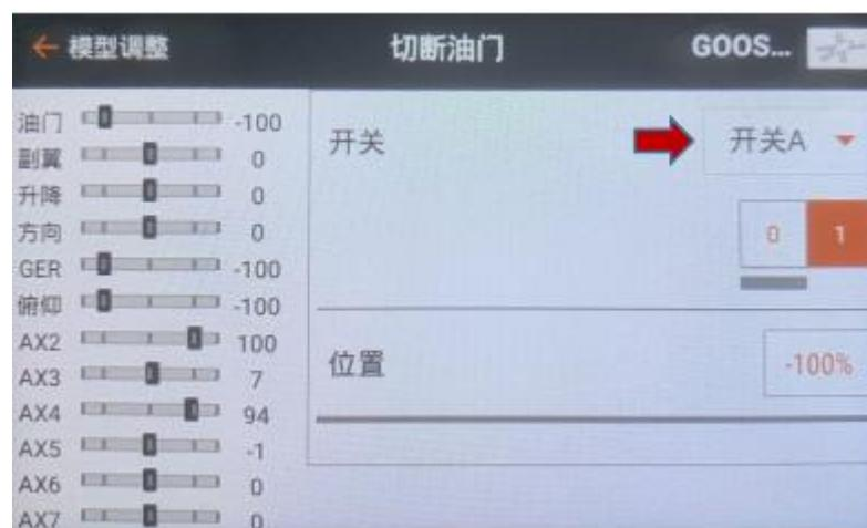
4. 设置飞行 3D 开关 Set the flight 3D switch
